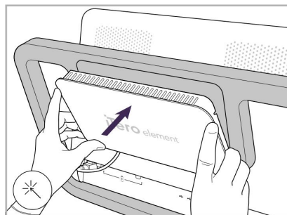
15. Fastgør det magnetiske bagdæksel.
